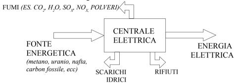
B. Schema a blocchi di una centrale TERMOELETTRICA a VAPORE alimentata a carbone/metano/olio combustibile
